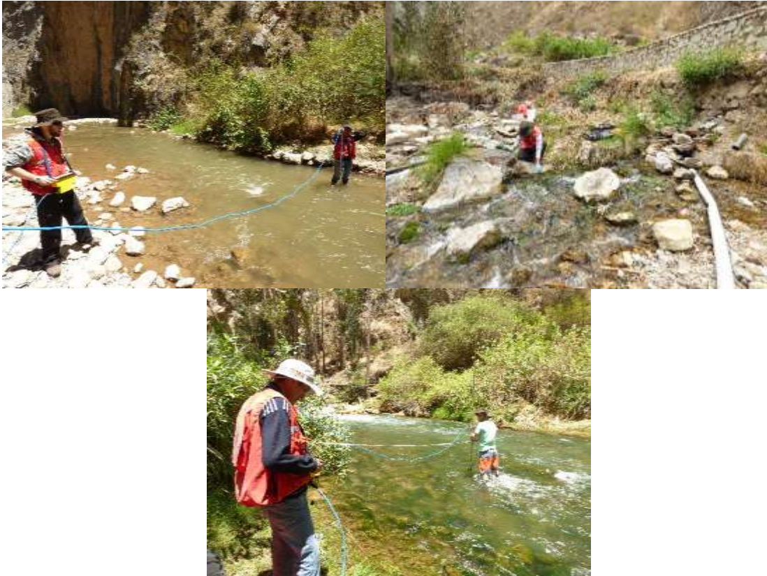
Fotografía 4: a) Medición del caudal en el río Alis, aguas arriba del manantial; b) muestreo del manantial Alis; c) medición del caudal del río Alis, aguas abajo del manantial
