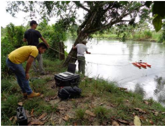
Figura 7 - Aforo del Río Negro con ADCP
