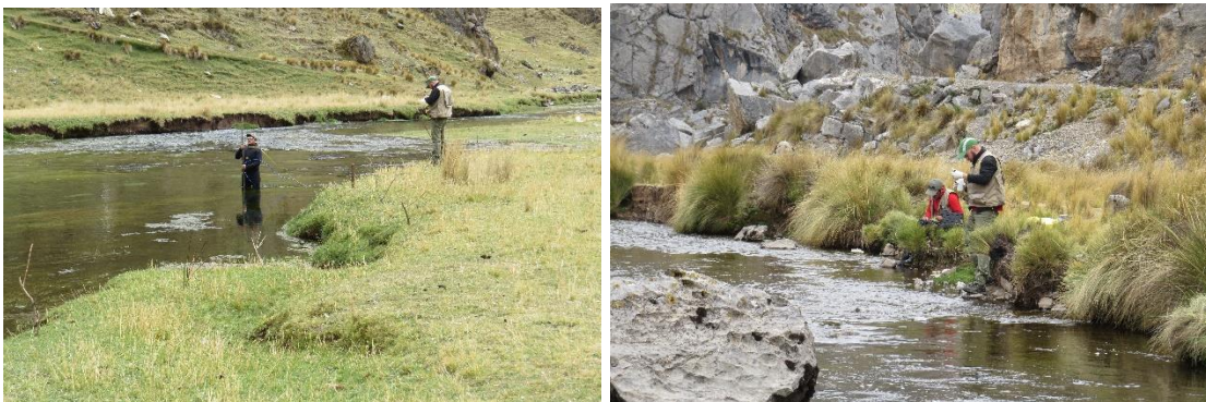
Photos 6 et 7: jaugeage de la résurgence Ucrumachay (g.) et échantillonnage du Tragadero (d.)
