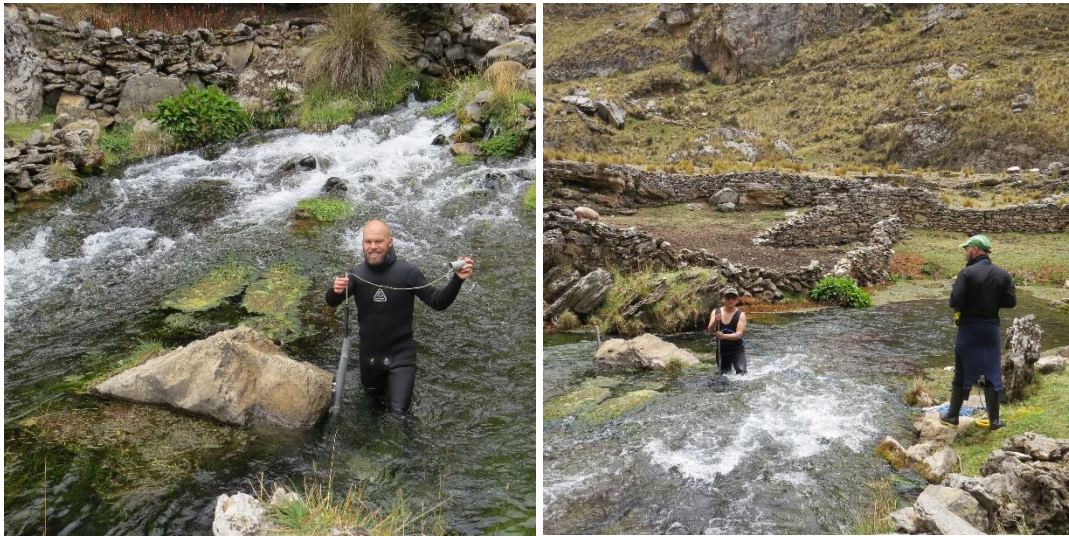
Photos 8 et 9: installation de la CTD (g.) et jaugeage de la résurgence Muyucocha (d.)
