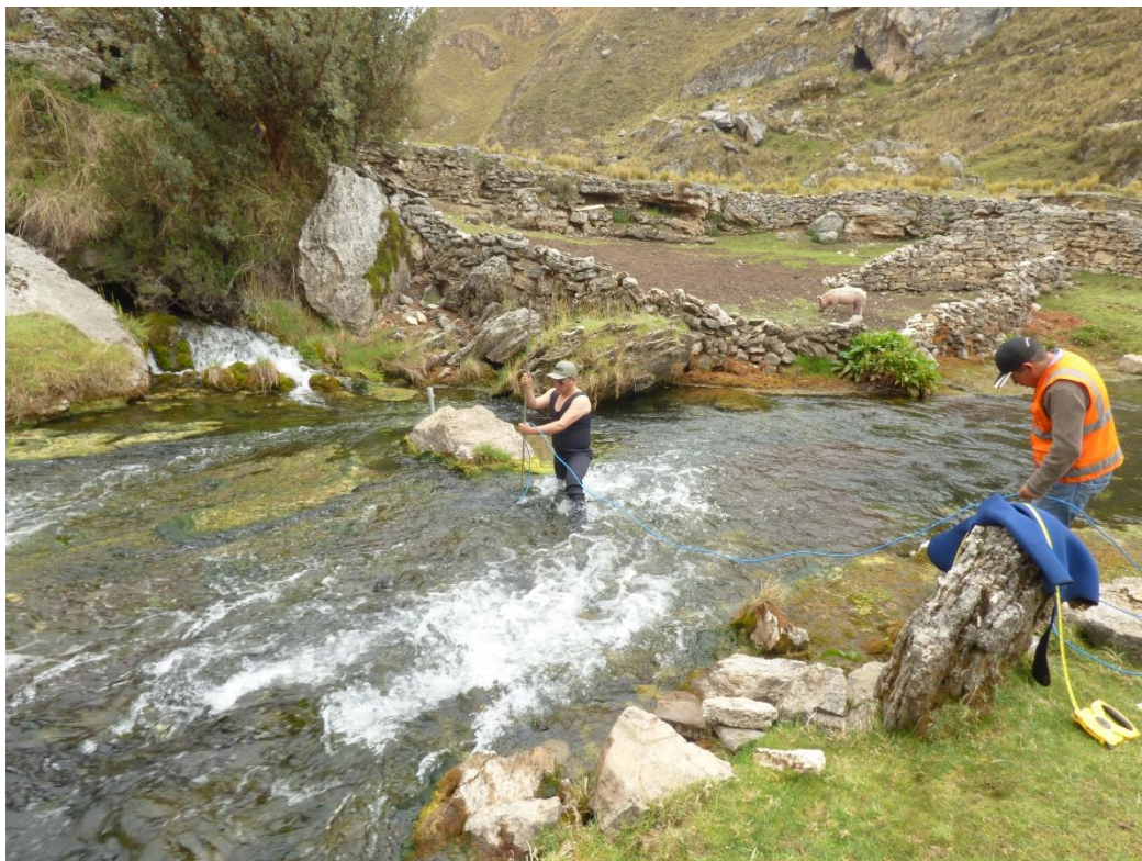
Photo 1 : jaugeage de la résurgence Muyucocha
