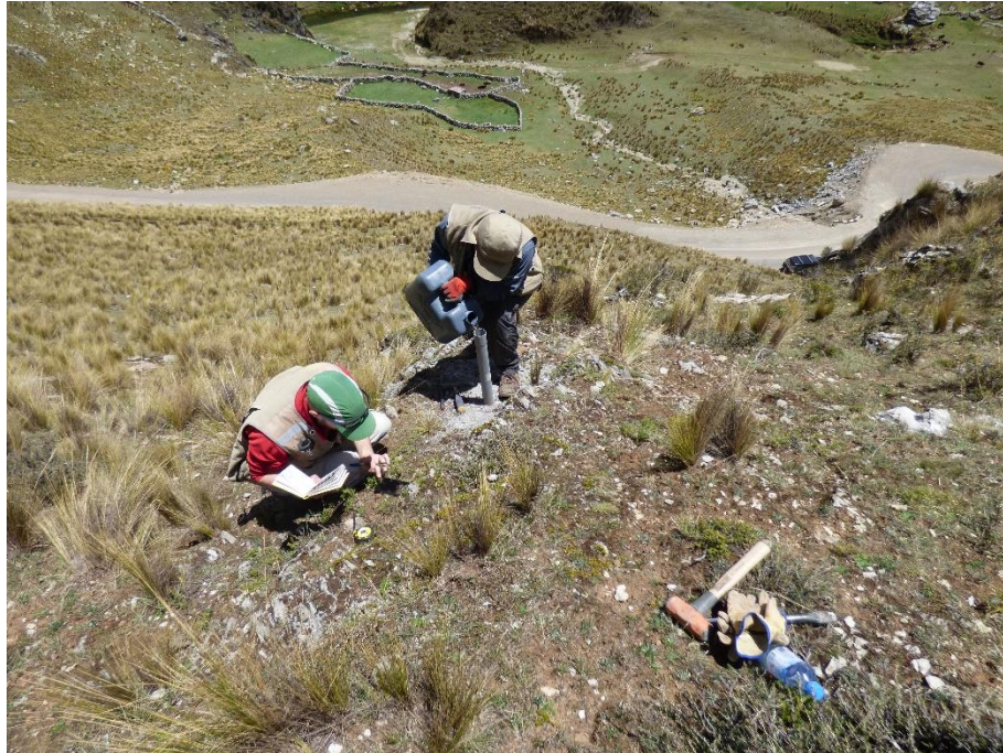
Photo 5: test de perméabilité sur un affleurement des calcaires Celendín
