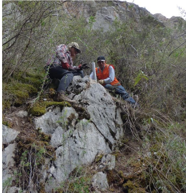
Photo 10: test de perméabilité sur un affleurement des calcaires Jumasha, au niveau du Tragadero du fleuve Cañete
