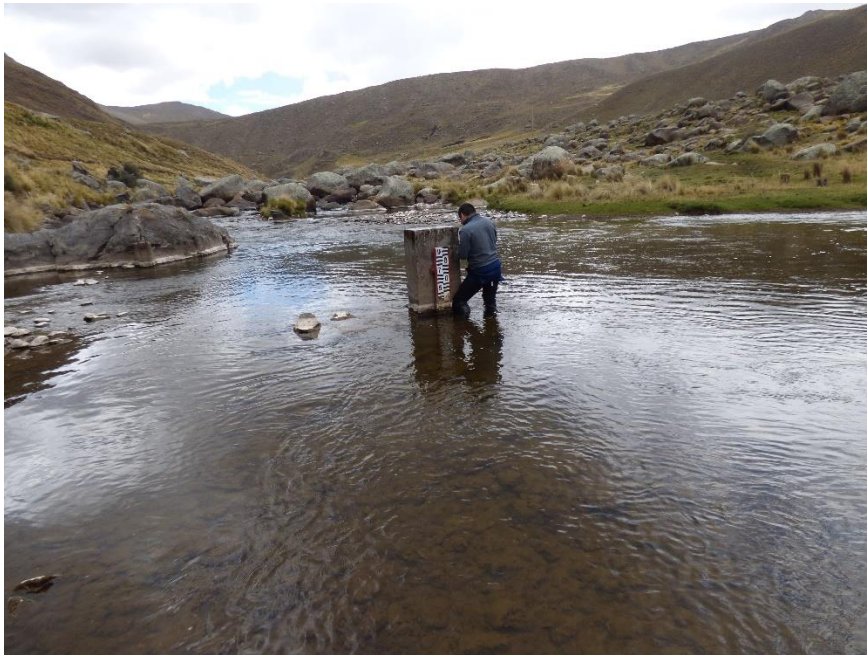
Photo 3: récupération des données de la CTD et échantillonnage du Tragadero
