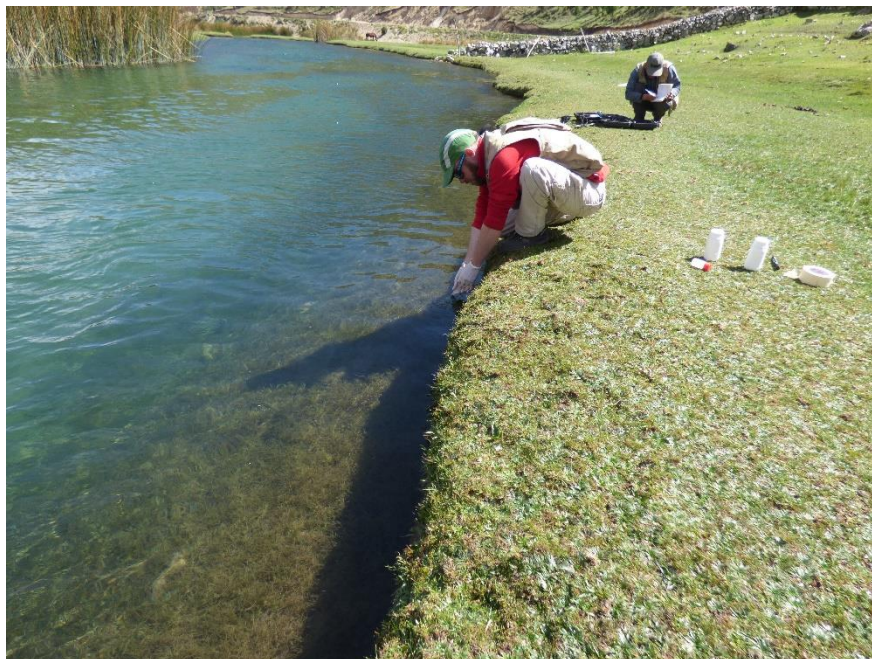
Photo 6: échantillonnage du fleuve Cañete au niveau de la station de jaugeage de Vilca
