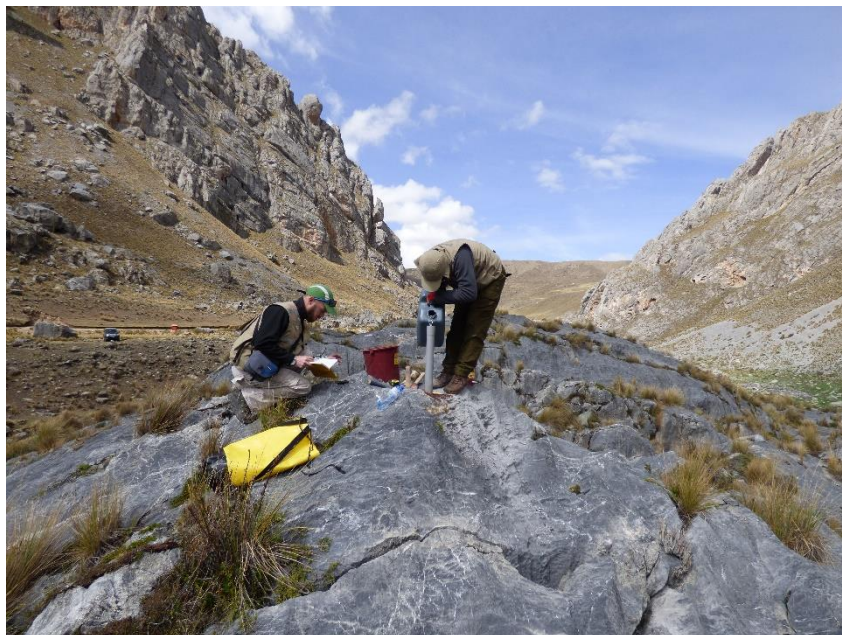
Photo 4: test de perméabilité sur un affleurement des calcaires Jumasha, au niveau du Tragadero du fleuve Cañete
