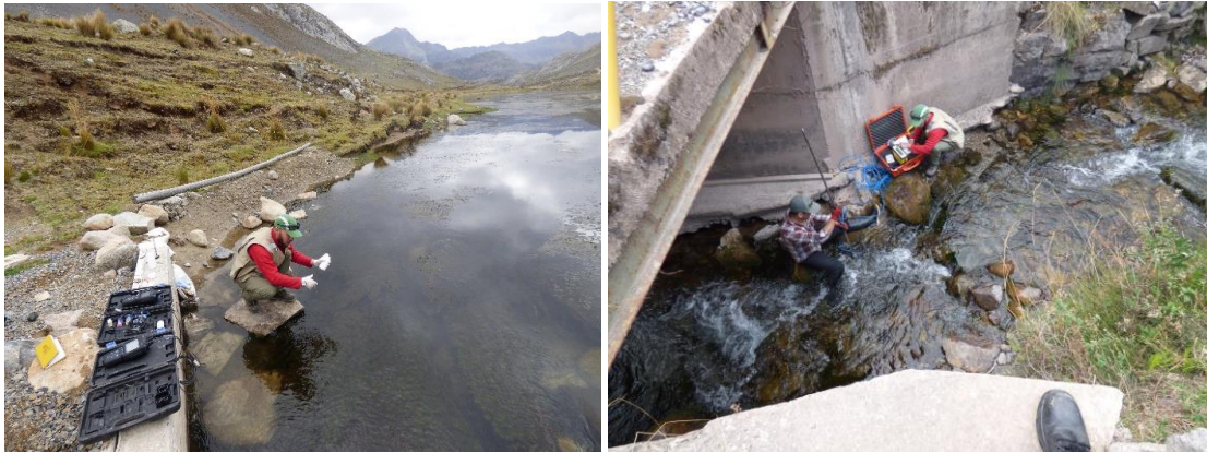
Photos 12 et 13: échantillonnage de la Sima Pumacocha (g.) et jaugeage du manantial Laraos (d.)
