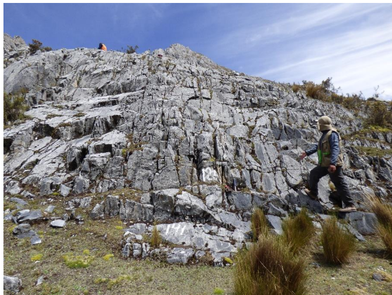
Photo 11: test de perméabilité et statistiques de fractures sur un affleurement des calcaires Jumasha, au niveau de la Sima Pumacocha
