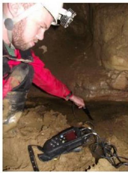
*Fotografía 1: izquierda: medición de los parámetros físico-químicos del agua afuera de la caverna; derecha: medición de los parámetros físico-químicos del agua en el sifón terminal de la caverna*
