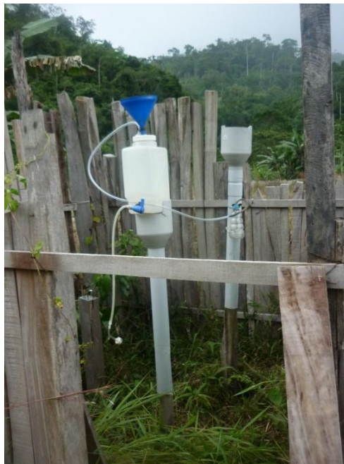
Colector de agua de lluvia para análisis de isotopos estables.
