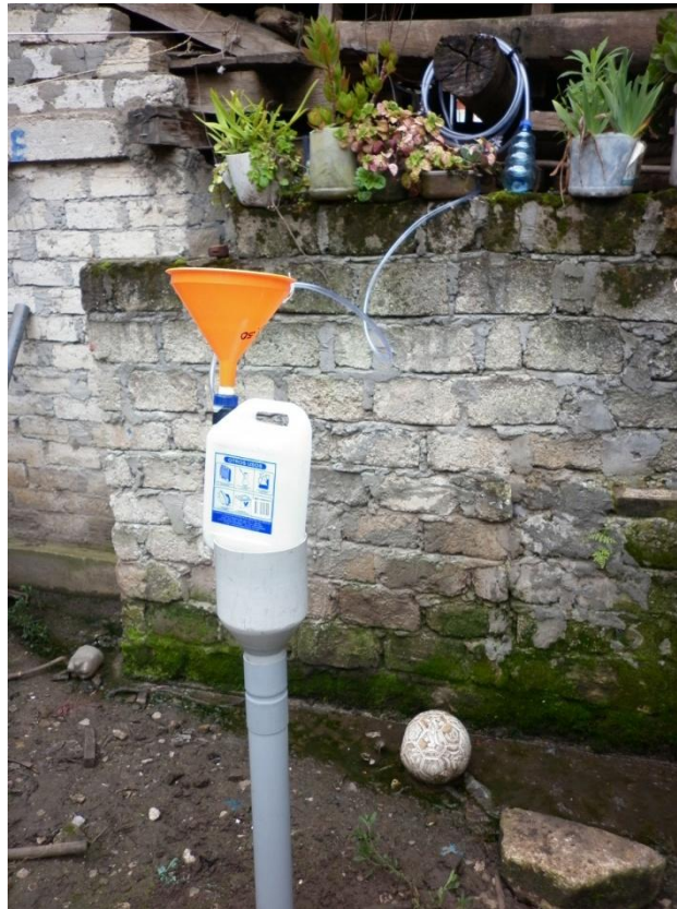
Colector de agua de lluvia para el análisis de isoopos de Oxigeno fuera del ambiente de la caverna
