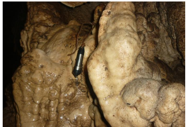
Instalacion del dripllogger de goteo rápido y el Baro para la monitoreo dentro de la caverna
