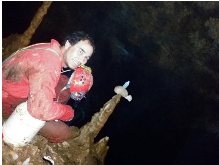
Colección de agua de goteo lento para el análisis de elementos mayores
