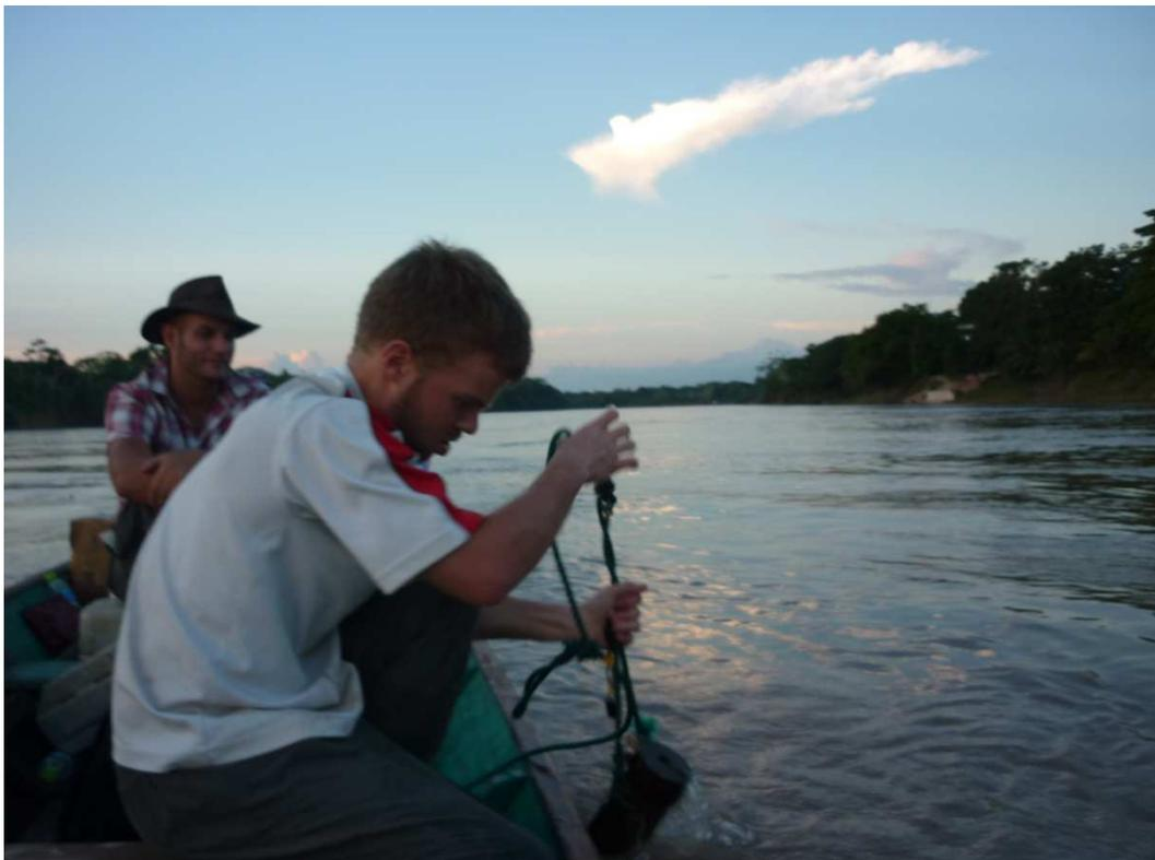
Figura 23: Colecta con granada de las muestras de agua para la medición de partículas en suspensión en diferentes profundidades.
