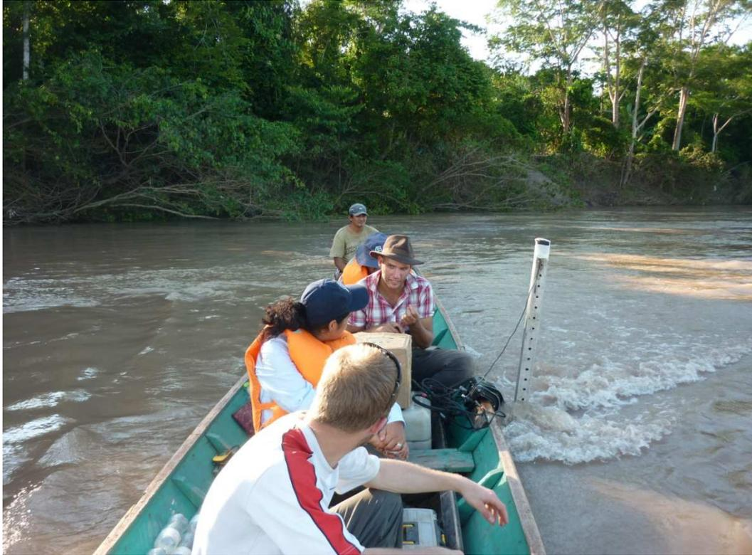
Figura 22: Aforo sobre río Pachitea en la sección transversal de la estación hidrométrica de Puerto Inca y explicación del trabajo desarrollado a los encargados del ANA (Autoridad Nacional del Agua: Sede Pucallpa).
