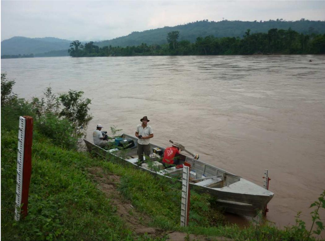
Figura 18: Disposición de las escalas limnimétricas en la estación hidrométrica de Chazuta
