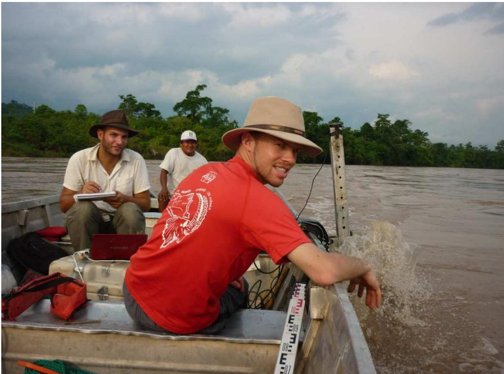
Figura 19: Aforo con ADCP en la sección del río correspondiente a la estación hidrométrica de Chazuta
