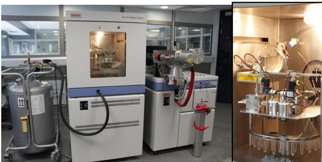
**Figura 5.3** - Foto do Kiel Device acoplado ao espectrômetro de massa de fonte gasosa, o painel direito mostra detalhe do Kiel Device e os vials de análise.
