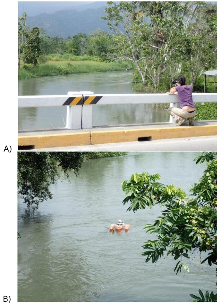
Aforo de Río Negro con Radar (A) y ADCP (B) en el puente de la carretera marginal de la Selva.
