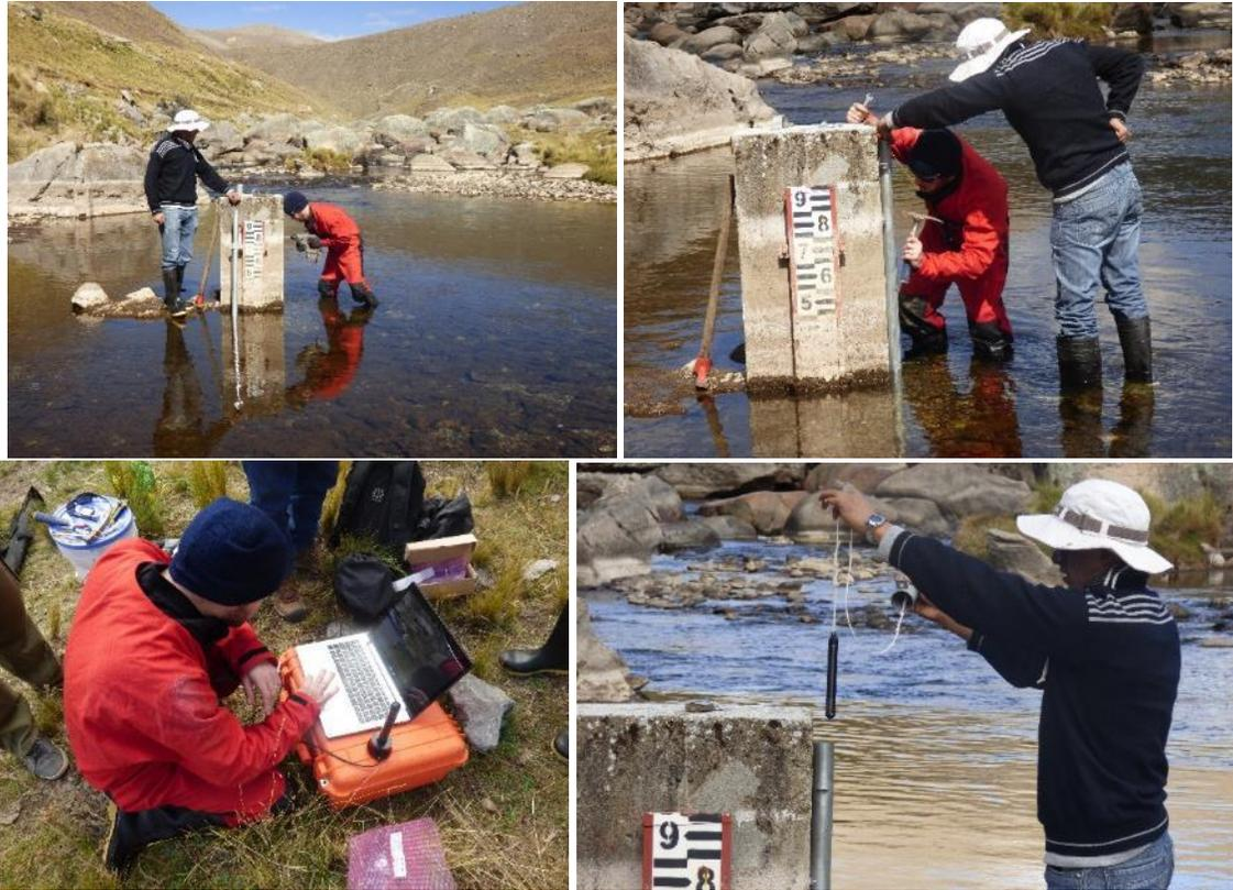
**Fotografía 1: calibración e instalación del captor CTD en el Tragadero del río Cañete**
