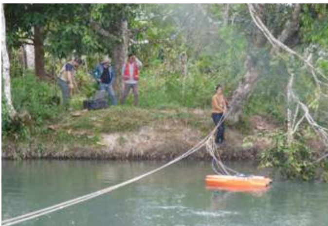
Jaugeage du Rio Negro avec radar et ADCP. (FR, 11/08/2017)
