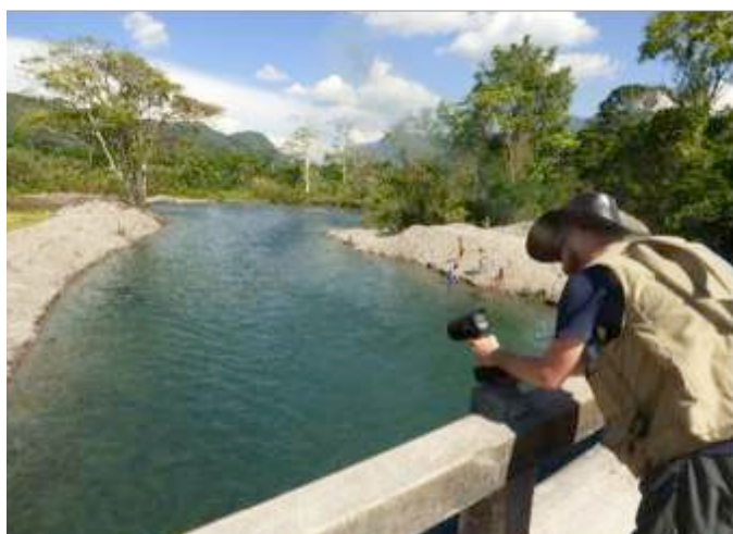
Jaugeage du Rio Negro avec radar et ADCP. (FR, 11/08/2017)
